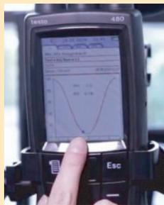
日本の断熱性能はヨーロッパはもとより、中国・韓国の基準と比較しても劣っています。九州住環境研究会は「HEAT20・G2基準」をベースに「ISO-7730」国際規格・PMV「予想平均温冷感申告」による、温熱環境の科学的な評価を行って、本当に建て主が快適に過ごせる住宅であるかどうか、実証的な工法開発に役立てています。左の測定写真の様に、建て主に高性能住宅の着衣量や代謝量（仕事量）による快適性の変化を示し、住宅の住まい方による、快適性と省エネ環境での暮らし方を紹介・指導しています。
